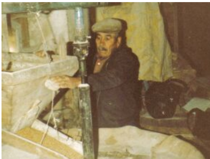
Fig. 7 – O Sr. Joaquim Duarte regula a inclinação da quelha, torcendo o cordel de suspensão.
