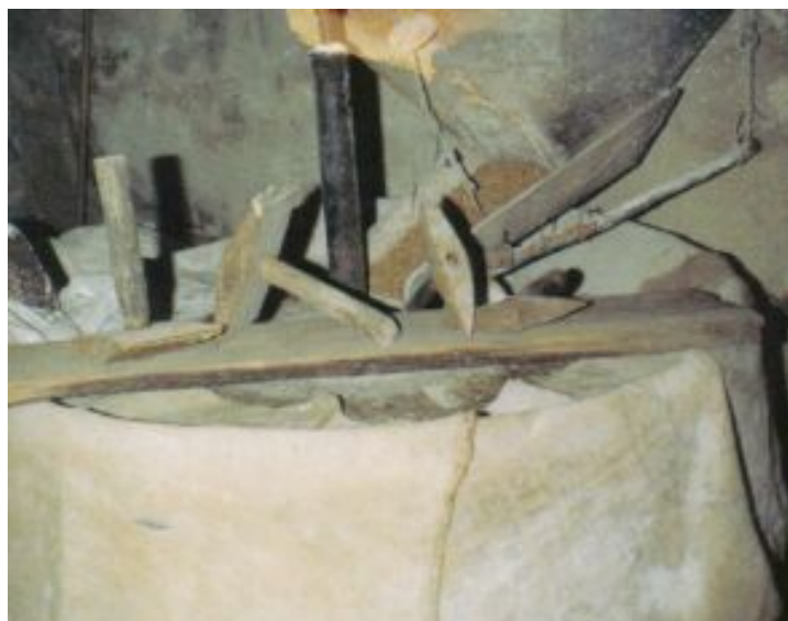
Fig. 5 – Ferramenta em uso na Azenha de Sevelas para picar as mós. Em exposição à frente da quelha, picadeiros (à esq. a ) e picões.
